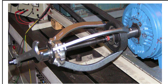
fig. 9.2: Demontage V-riemschijf met poelietrekker
