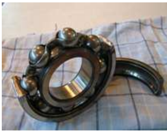
fig. 9.9: Beschadigde lager Case 1
